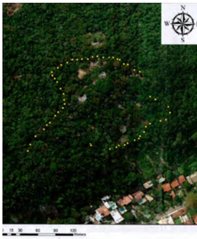
Figura 2. Delimitação do Sítio da Jaqueira, Morro das Andorinhas, GPS MAP 64s Garmin, Sistema de referência SIRGAS 2000, UTM Zona 23s. Altitude estimada pelo GPS entre 90 e 120 metros. (Dado coletado pelo PESET em fevereiro/2016 e fornecido pela ACOTMA).
