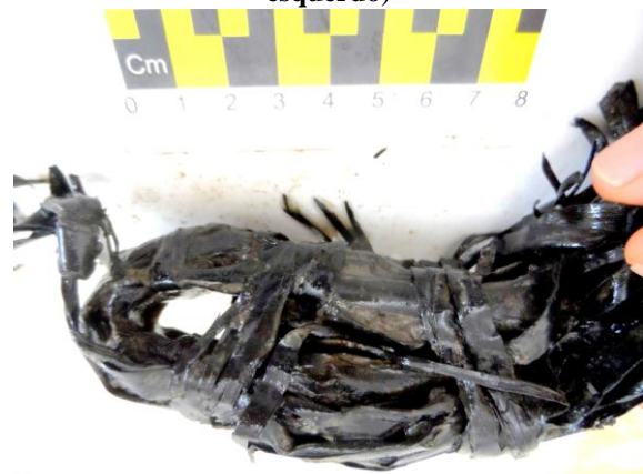
Figura 12 - Amarração tipo alça, (Artefato 9) contendo um acabamento com nó direito (lado esquerdo)
